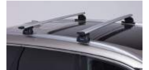
القضبان المتقاطعة قضبان فولاذية مدمجة في قضبان السقف الموجودة، الحد الأقصى للوزن ٧٥ كجم.
