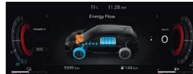
مقياس رقمي لتدفق الطاقة Digital combimeter with energy flow
