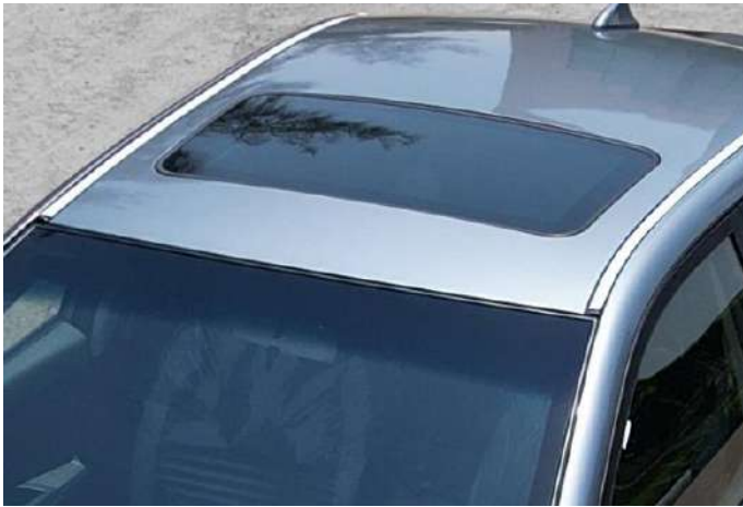
فتحة سقف كهرباء
