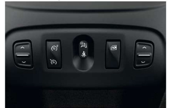
Cruise Control & Speed Limiter مثبت و محدد للسرعة
