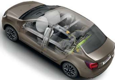
Dual Airbags (Driver and Passenger) وسائد هوائية للسائق و الراكب الأمامي
